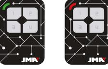
Si le témoin passe au rouge fixe cela veut dire qu'il s'agit d'une télécommande Rolling Code et il est par conséquent nécessaire d'appliquer une deuxième trame\*\*
