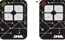
Si le témoin passe au rouge intermittent, le code n'a pas été correctement capturé. Il faut procéder à une nouvelle capture en rapprochant ou en éloignant la télécommande d'origine.
